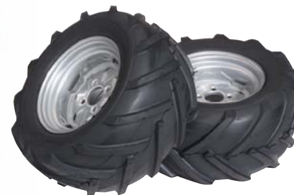
Tractorprofielbanden zorgen voor extra tractie op gladde en modderige ondergrond.
